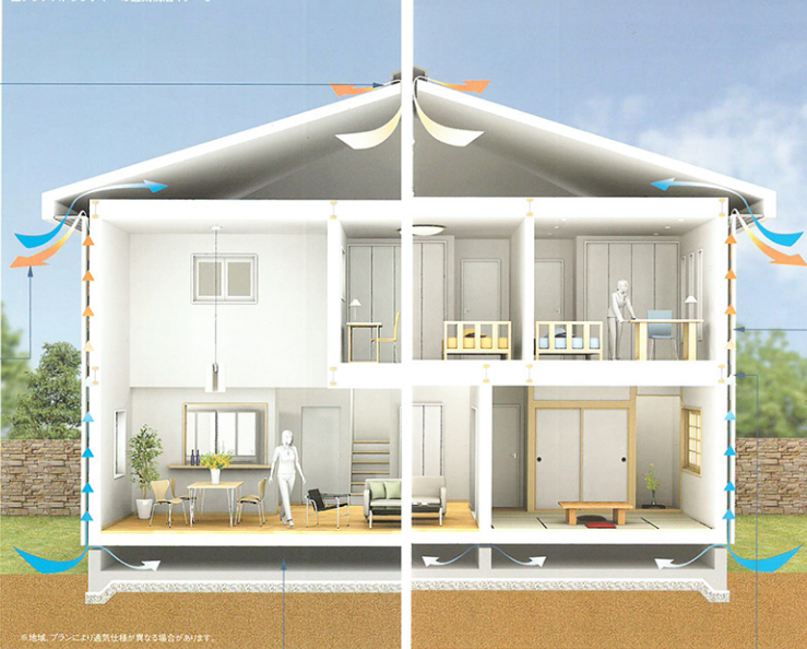
■テクノストラクチャーの通気構造イメージ
