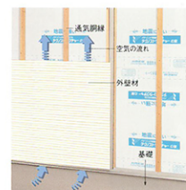
●壁体内通気構造 土台水切から空気を取り入れ壁内通気層を通り、軒下または屋根裏より湿気が排出されます。
